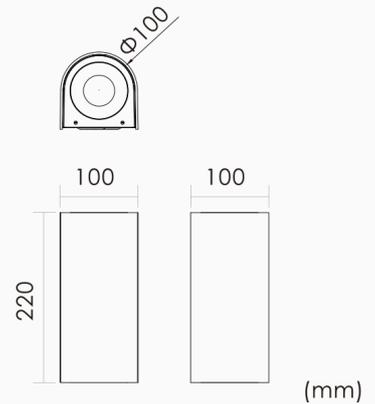
Das Gehäuse besteht aus durchgehend druckgegossenem Aluminium, was für eine gute Wärmeableitung sorgt. Optional sind DALI2 sowie drahtlose, intelligente Dimmfunktionen verfügbar. Die WALL-R eignet sich ideal für Fassaden- und architektonische Akzentbeleuchtung im Aussenbereich – kann aber auch im Innenbereich eingesetzt werden. Produkteigenschaften: Direkte und indirekte Beleuchtung Optional: DALI2, drahtloses intelligentes Dimmen Schutzart IP65
