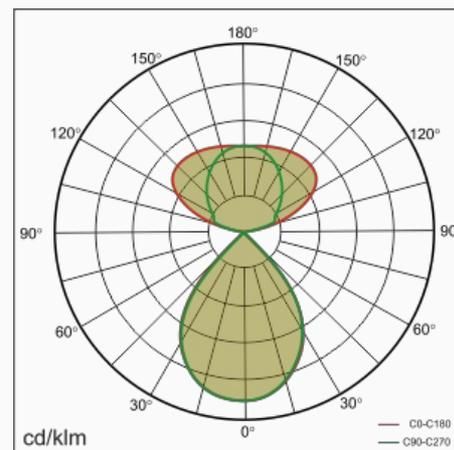
Wir haben RAY\_P mit einem Konzept von einfach, modisch und phantasievoll entworfen. Mit ausgezeichneter Handwerkskunst und strengen Standard für Materialien. . Wir verwenden spezielle Mikro-Reflektor und Anti-Glare-Abdeckung, UGR<15, komfortable und weiche Lichtverteilung durch verschiedene Abstrahlwinkel für direkt 80° & indirekt 140°. Breiter Abstrahlwinkel mit professionellem Blendschutzdesign, UGR<15 Modulare lineare Anwendungen DALI und 1-10V Tunable white CASAMBI
