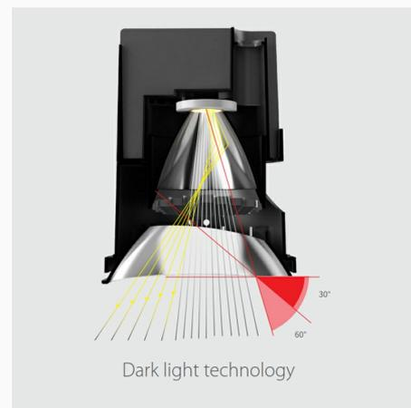
Der Einbaustrahler NR-LKR-20W-930-Dali aus der Familie LKR besteht aus Aluminium-Druckguss. Der Strahler ist direkt abstrahlend und entspricht IP20. Flexible Einsatzmöglichkeiten sind durch die umfassenden Einstellmöglichkeiten gegeben. 20W LED, 1800 Lumen, 90 Lumen/Watt, 3000 Kelvin. Ø110xH121.5mm, Ausschnitt: D = 95 mm, CRI>90, UGR<16. Breitstrahlend 50°. Weiss mit Schwarmatten Abblendreflektor, Mit DALI Betriebsgerät, Flimmerfrei.
